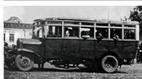
Автобус на базе автомобиля ЗиЛ-35 с открытым кузовом, выпускавшийся на протяжении всего периода выпуска ЗиЛ-35, 1933 год.
