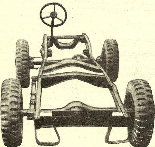
Шасси автомобиля без двигателя и трансмиссии.
