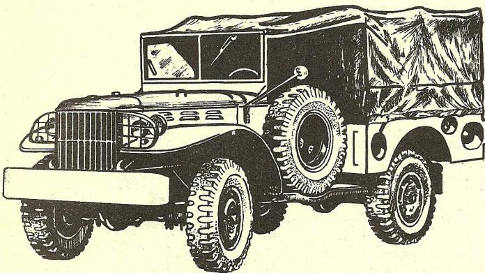
Армейские автомобили «Додж» типа WC по конструкции и дизайну — типичные представители американской автомобильной промышленности времен второй мировой войны. Они отличались технологичностью в массовом производстве и ремонте, достаточной надежностью и проходимостью, высокой степенью стандартизации и унификации, строго функциональной внешностью.
