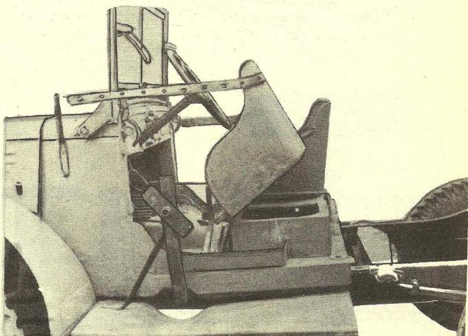
Вид на кабину водителя (грузовой кузов снят). Сиденья поднято и зафиксировано ремнем за стойку зеркала заднего вида (в рабочем положении ремень крепится за кольцо на краю приборной доски). На переднем плане — кронштейн крепления запасного колеса.
