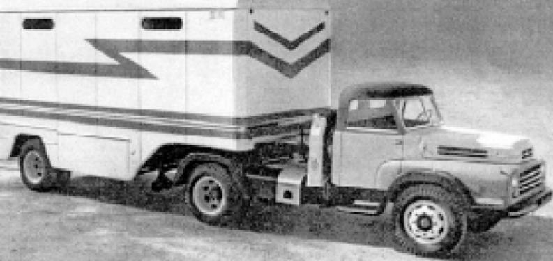
Седельный тягач Czepel D-450N с изотермическим полуприцепом-фургоном
