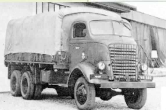
GMC AFKWX 353 с закрытой кабиной (тип 1615) и 15-футовой грузовой платформой
