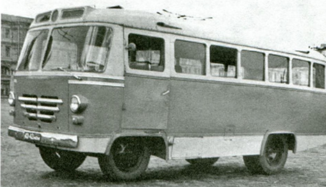
Один из многих КАГ-3 второй серии после капитального ремонта приобретший новую облицовку, но сохранивший составное лобовое стекло старого типа. Фото нач. 1970-х гг.
