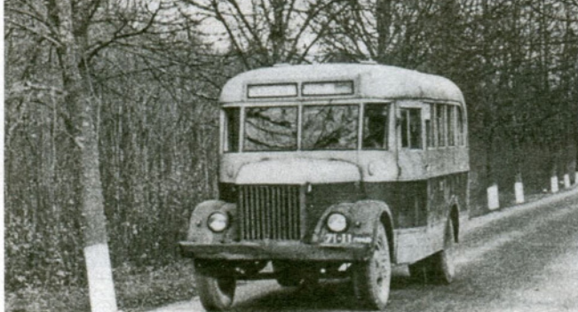
Поздние исполнения КАГ-1 имели более простые лобовые стёкла. 1955
