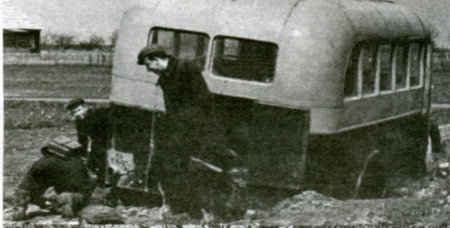
В задней стенке КАГ-1 с округлым верхом и иными окнами был открывавшийся бок багажный люк
